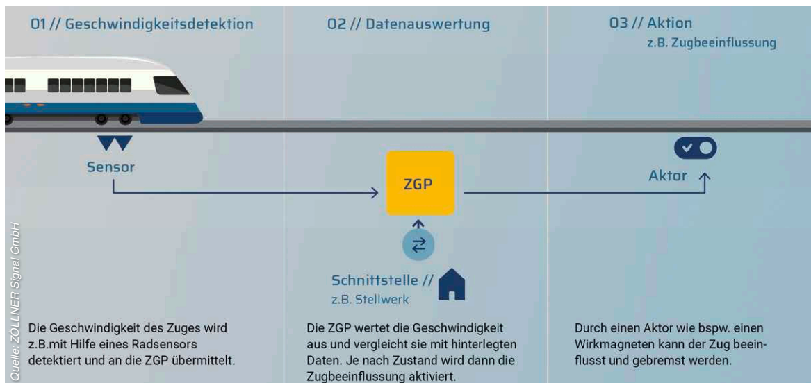
Aufbau des Systems mit Sensor, Auswertung und Aktor. Individuell anpassbare Schnittstellen beispielsweise zum Stellwerk und zur Ferndiagnose sind möglich
